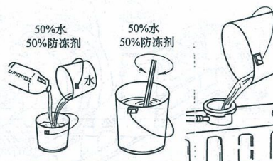
图 1-368 加注冷却液检查有无泄漏
